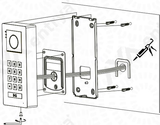
1. Percez des trous dans le mur et fixez le cadre de montage.
