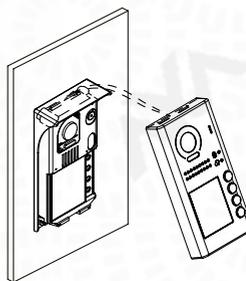
Suspendez la plaque frontale derrière la languette supérieure et glissez cette sur le boîtier.
