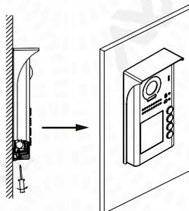
Bevestig de frontplaat aan de kunststof behuizing met het meegeleverde schroefje.
