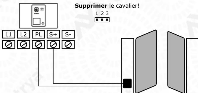
Raccordez le sortie du poste extérieur sur l'entrée d'impulsion de la commande.
