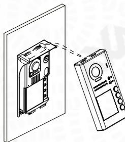
Hang de frontplaat achter de kunststof lip aan de bovenzijde en schuif deze over de plastic behuizing.
