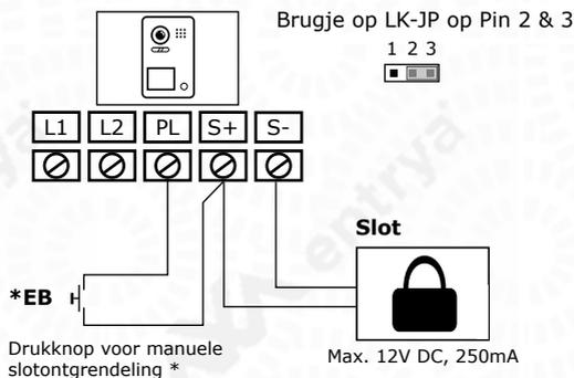
\* Het slot is ontgrendeld zolang de drukknop blijft ingehouden.
