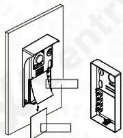
Retirez le couvercle en plastique derrière la fenêtre transparente pour le porte-nom. Déposez le porte-nom derrière la fenêtre et remettez le couvercle en place.
