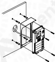
Bevestig de buitenpost en de regenkap met de meegeleverde schroeven. Sluit de kabel aan op de buitenpost. Kit vervolgens de boven- en zijkanten van de regenkap af met siliconenkit.
